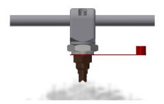
2. Le brouillard d'eau se répand dans le compartiment moteur.
